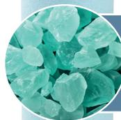
**Cristaux de silicophosphate : Antitartre et anticorrosion**
