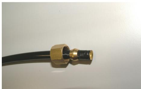
9 – Visser le tube et l'écrou en sortie du robinet avec la clef de 10.
