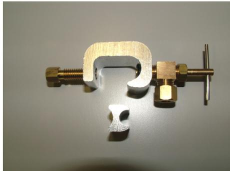
3 – Placer le robinet sur le tube en cuivre.
